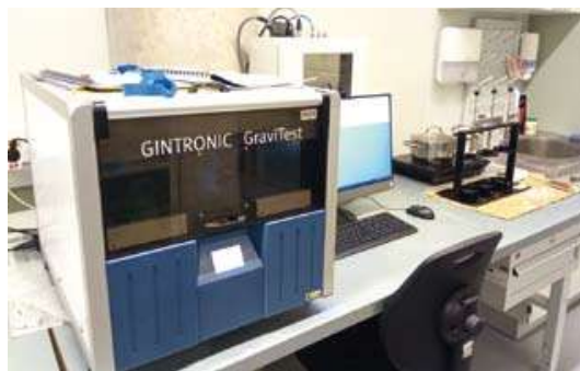
6. attēls. Gintronic GraviTest iekārta materiālu (plēves, membrānas, būvmateriāli) ūdens tvaiku caurlaidības standartizētai noteikšanai.
