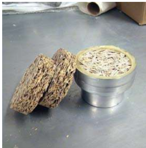
5. attēls. Sagatavoti un tīģeļi ievietoti fibrolīta paraugi tvaiku caurlaidības testēšanai.
