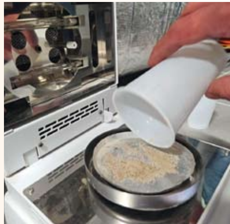
Precīzai mitruma noteikšanai ēku sienās tiek izmantota svaru metode.
