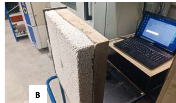
5. attēls. Eksperimentālais stends mitruma un žūšanas kontrolei nenosegtiem un nosegtiem paraugiem (A); paraugi pēc atveidošanas (B); parauga šķērsgriezums (C).
