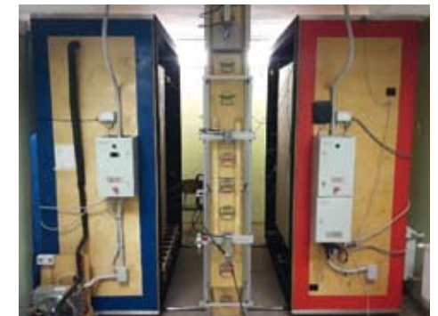
7. attēls. Hot Box iekārta gatavo būvizstrādājumu (logi, durvis, āršien elementu) siltuma caurlaidības (U-vērtība) standartizētai noteikšanai.
