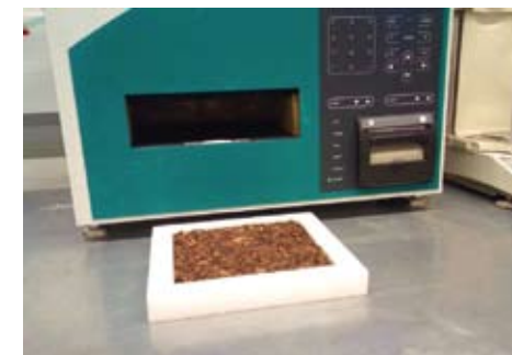
2. attēls. Iekārta Netzsch HFM 446 plāksņveida un beramu materiālu siltuma vadītspējas un siltuma ietilpības standartizētai noteikšanai.
