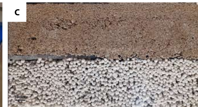
5. attēls. Eksperimentālais stends mitruma un žūšanas kontrolei nenosegtiem un nosegtiem paraugiem (A); paraugi pēc atveidošanas (B); parauga šķērsgriezums (C).
