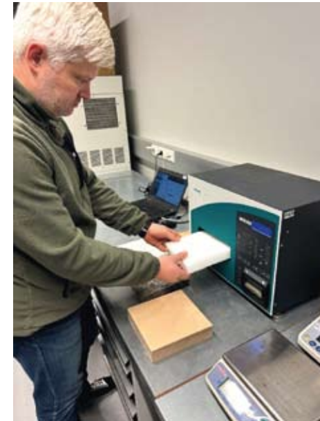
5. attēls. Materiālu paraugu ievietošana iekārtā Netsch HFM 446 siltuma vadītspējas un siltuma ietilpības testēšanai.
